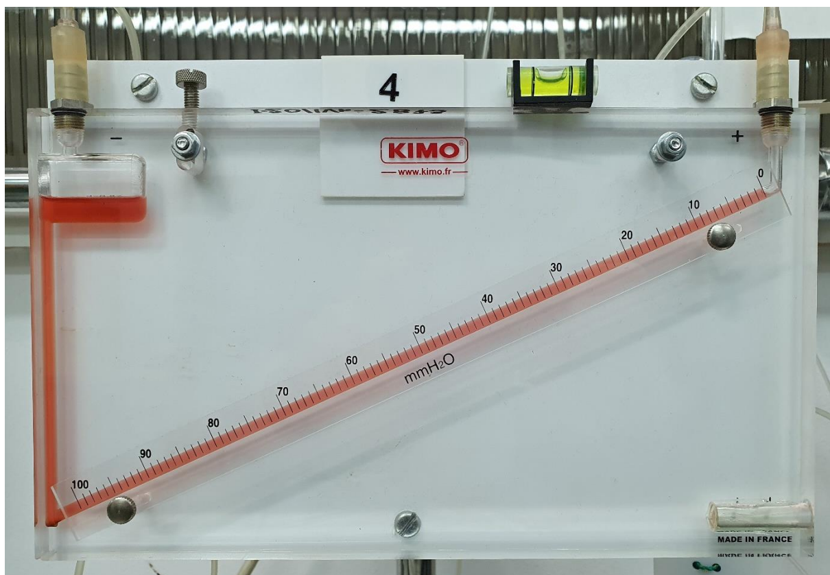
Rys. 19. Manometr skośny o zakresie pomiarowym 100 mm H 2 O.
