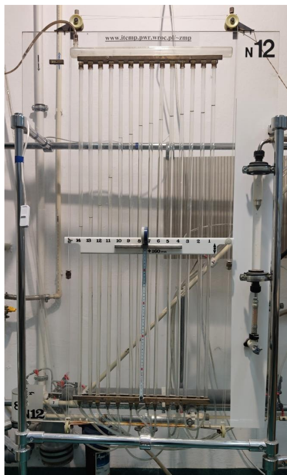
Rys. 10. Bateria piezometrów z układem pomiarowym
