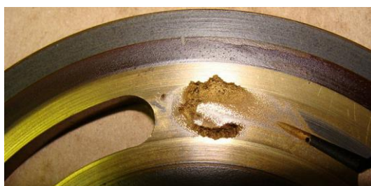
Rys. 10. Erozja na powierzchni elementu pompy [ https://commons.wikimedia.org/wiki/File:Cavitation.jpg ].
