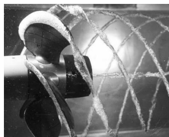
Rys. 4. Kawitacja na śrubie okrętowej. [ https://commons.wikimedia.org/wiki/File:Cavitation.jpg ]
