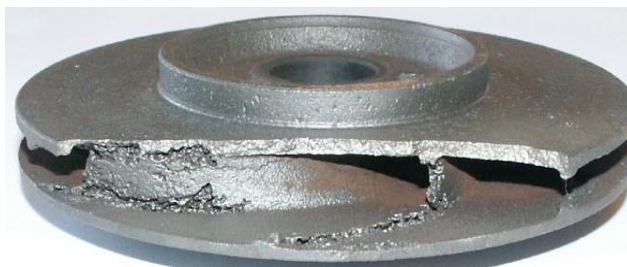
Rys. 9. Erozja na powierzchni elementu pompy [ https://pl.wikipedia.org/wiki/Plik:Kavitation_at_pump_impeller.jpg ].
