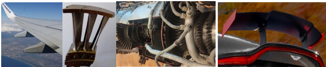
Rys. 1. Ciała opływowe: a) skrzydło; b) łopátka turbiny, c) łopátka sprężarki, d) spojler.
