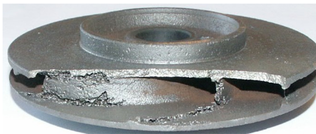
Rys. 9. Erozja na powierzchni elementu pompy [ https://pl.wikipedia.org/wiki/Plik:Kavitation_at_pump_impeller.jpg ].
