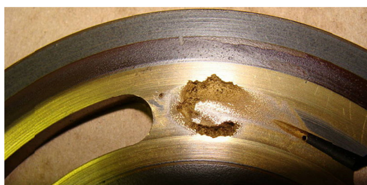
Rys. 10. Erozja na powierzchni elementu pompy [ https://commons.wikimedia.org/wiki/File:Cavitation.jpg ].
