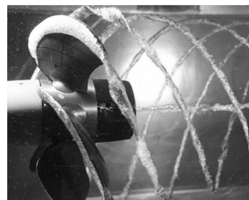
Rys. 4. Kawitacja na śrubie okrętowej. [ https://commons.wikimedia.org/wiki/File:Cavitation.jpg ]
