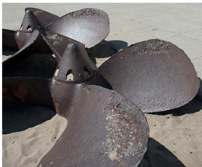
Rys. 11. Erozja na powierzchni śruby okrętowej [ https://www.nps.gov/safr/learn/historyculture/propsaquaticpark.htm ].
